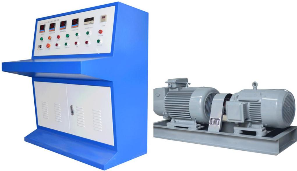
变压器感应耐压试验装置（成套图）
