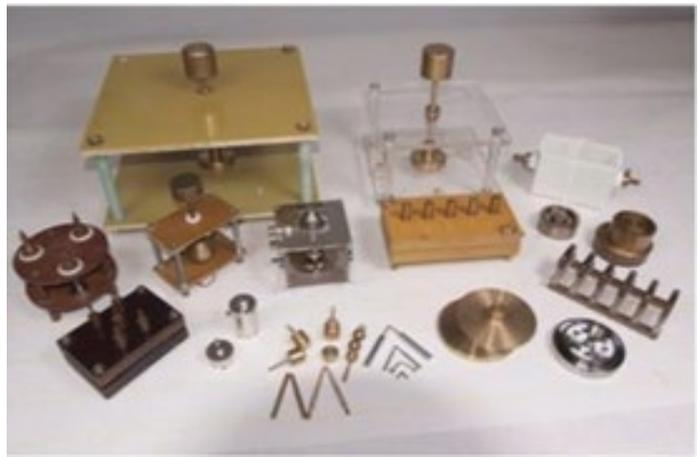
由于实验固体绝缘材料如电线套管、树脂和胶、浸渍纤维制品、云母及其制品、塑料、薄膜复合制品、陶瓷和玻璃等介质的样品多样，击穿电压电极标配为直径 25mm 的柱形电极 1 套、球形和柱形组合电极 1 套。其他试样电极为选配件，订货前请联系我司。
